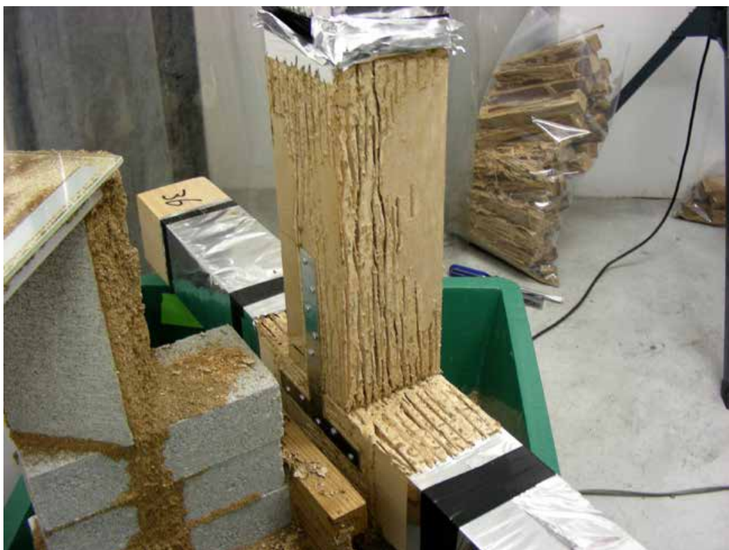
写真 5.6 写真 5 の蟻土を除去したときの蟻害発生状況 (期間：2週間後、樹種：ベイツガ)
