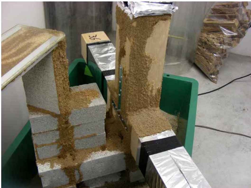
写真 5.4 試験体を組んだ状態で強制劣化操作している様子 (期間：10 日後、樹種：ベイツガ)
