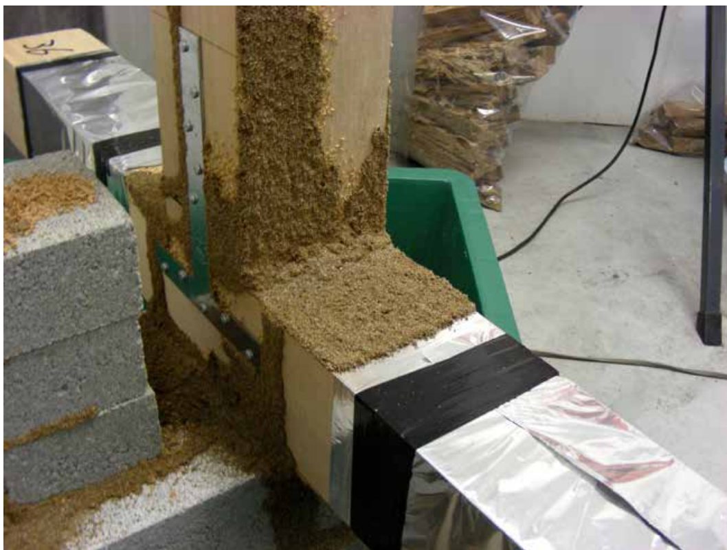
写真 5.3 試験体を組んだ状態で強制劣化操作している様子 (期間：6 日後、樹種：ベイツガ)
