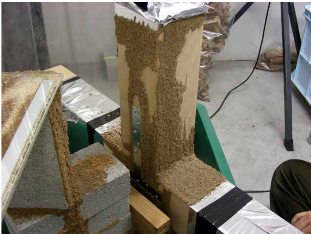
写真 5.5 試験体を組んだ状態で強制劣化操作している様子 (期間：2週間後、樹種：ベイツガ)
