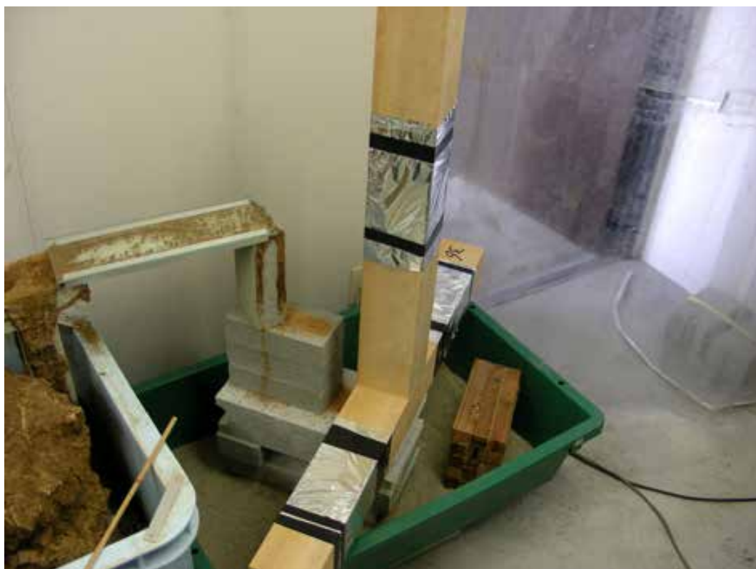
写真 5.1 試験体を組んだ状態で強制劣化操作するためのイエシロアリの誘導方法 (左側容器：イエシロアリの巣、右側容器：ベイツガ試験体)
