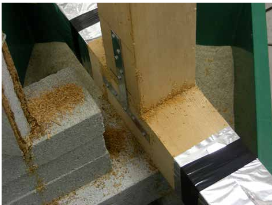
写真 5.2 試験体を組んだ状態で強制劣化操作している様子 (期間：3 時間後、樹種：ベイツガ)
