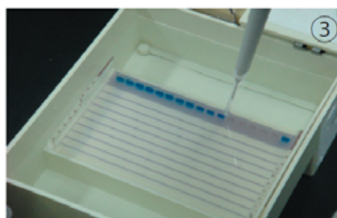
電気泳動で特異的に切られた遺伝子の長さを調べる。
