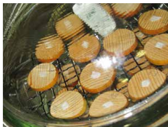
図 6.2.2 試料設置状況（左：直接接種、右：間接接種）
