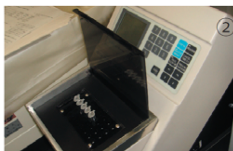
サーマルサイクラー（遺伝子を増幅する装置）で遺伝子を増幅する。
