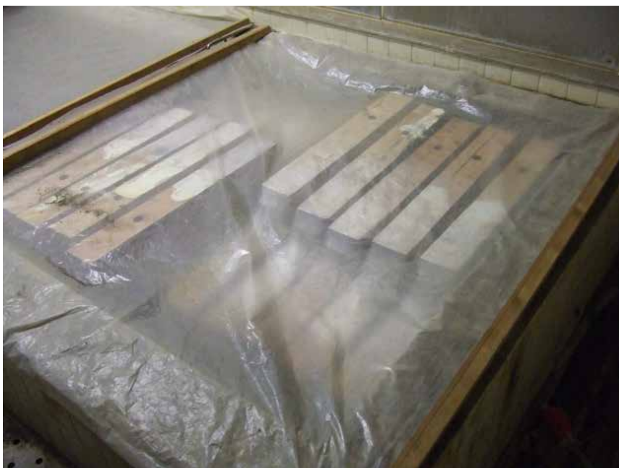
写真５．３．２ 改良した菌床による強制劣化操作の試験体設置方法の様子 (菌床：チョークアナタケ、撮影場所：恒温恒湿室)
