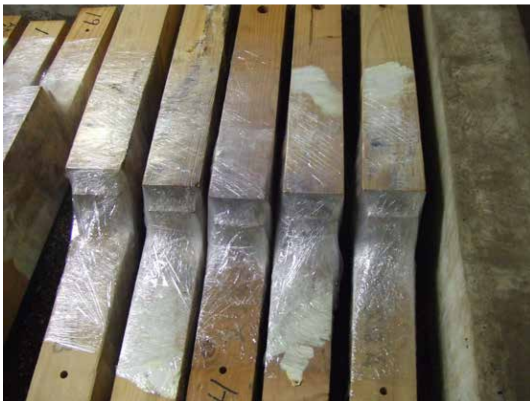
写真5. 3. 3 (b) 目視で菌糸の確認ができる試験体を拡大した様子 (菌床：チョークアナタケ、撮影場所：恒温恒湿室)
