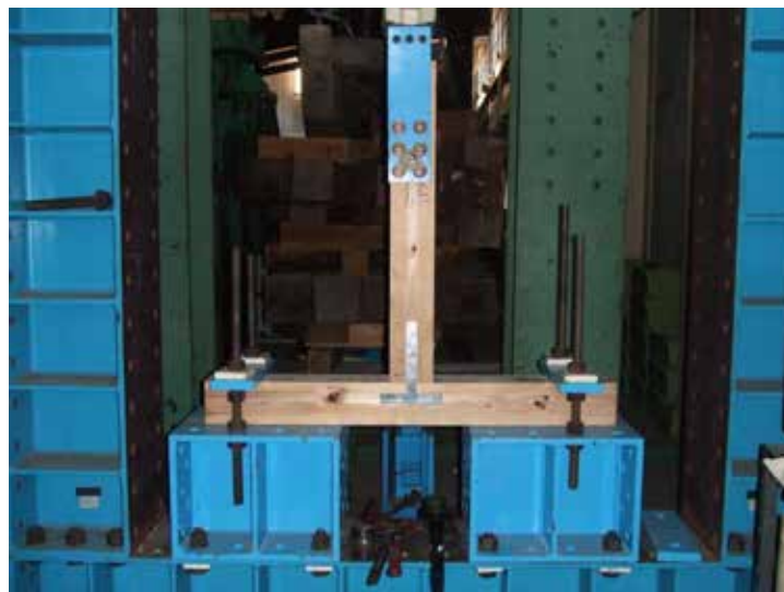
写真 5. 2. 1 接合部モデル試験体の強度試験の様子
