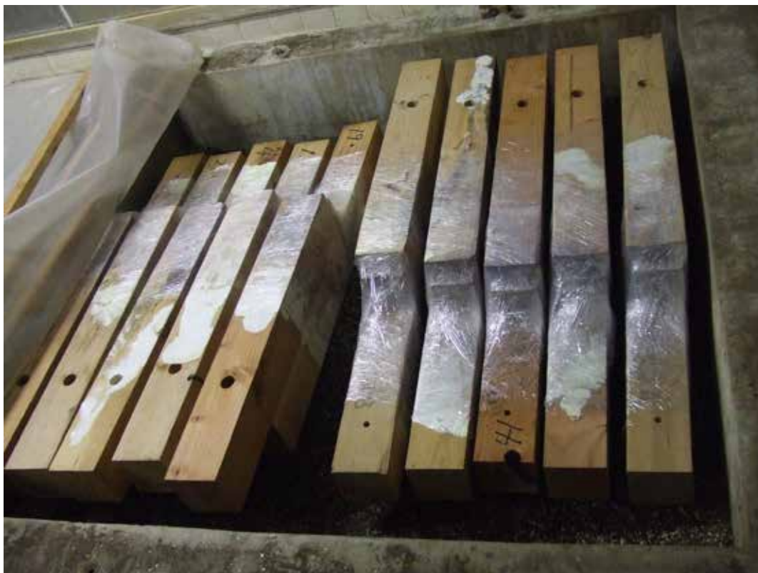
写真5. 3. 3 (a) 目視で菌糸の確認ができる試験体の様子 (菌床：チョークアナタケ、撮影場所：恒温恒湿室)
