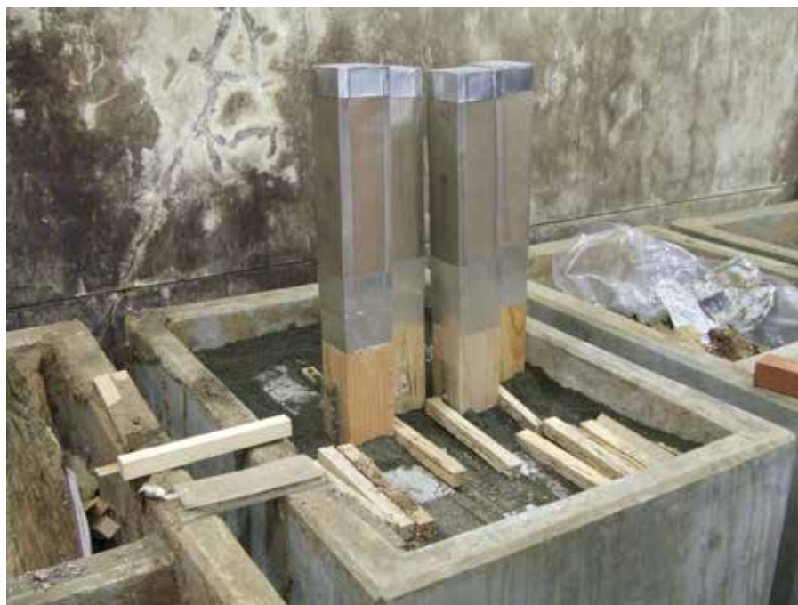
写真 5. 3. 1 シロアリによる強制劣化方法を実施した接合部モデル試験体の様子 (複数同時による操作、開始直後)
