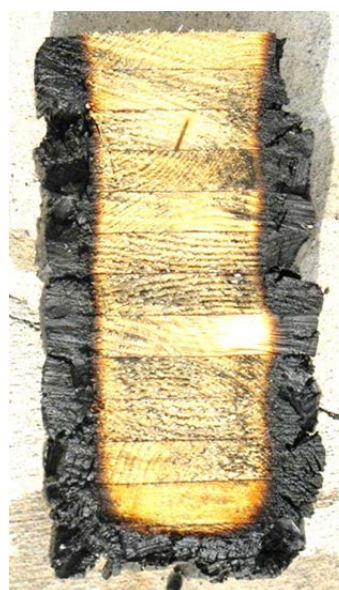
写真 4.3-1 45 分加熱後の PRF 試験体断面
