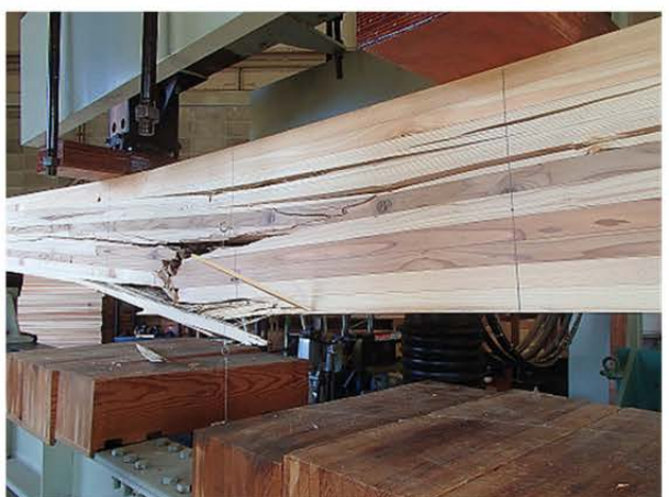
図3.1-6 AAC-I-1の曲げたわみー曲げ応力曲線および破壊形態
