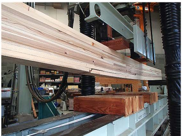
図3.1-3 AAC-3の曲げたわみー曲げ応力曲線および破壊形態
