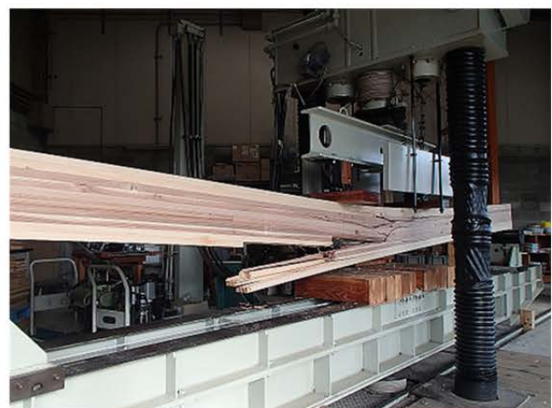
図3.1-12 AZN-2の曲げたわみー曲げ応力曲線 および破壊形態
