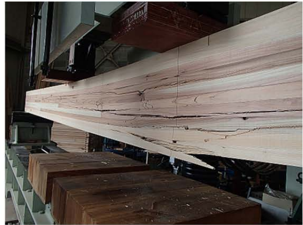
図3.1-16 AZN-I-1の曲げたわみー曲げ応力曲線 および破壊形態
