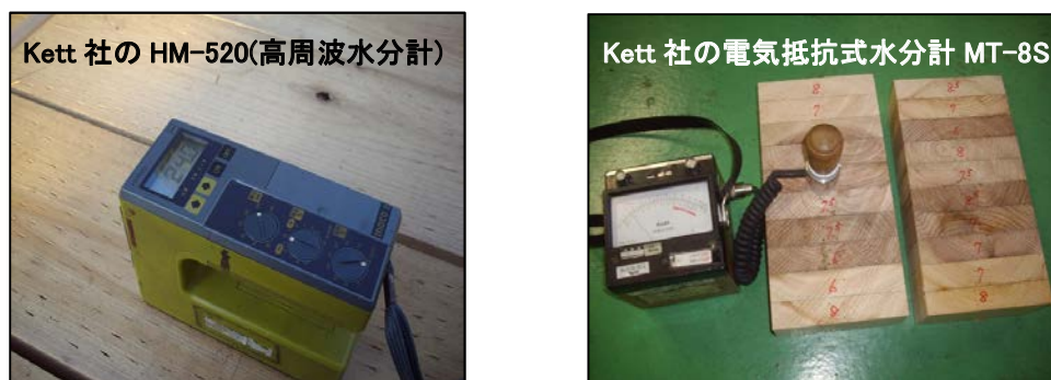
写真 2.3-2 ラミナ及び集成材の含水率測定に使用した含水率計
