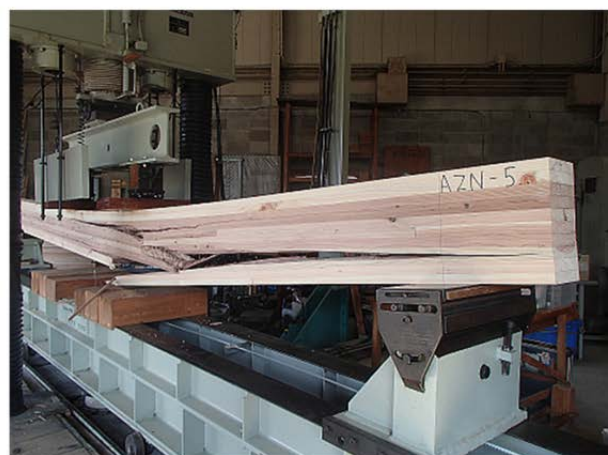
図3.1-15 AZN-5の曲げたわみー曲げ応力曲線および破壊形態
