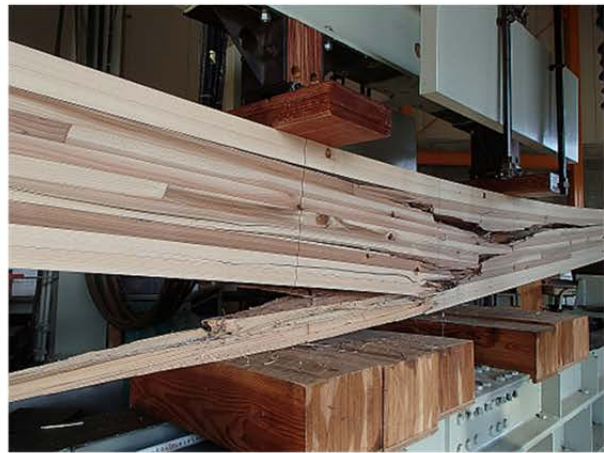
図3.1-8 AAC-I-3の曲げたわみー曲げ応力曲線 および破壊形態
