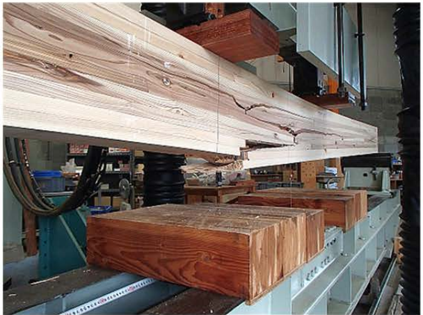
図3.1-2 AAC-2の曲げたわみー曲げ応力曲線および破壊形態
