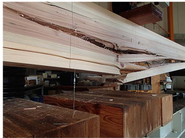
図3.1-13 AZN-3の曲げたわみー曲げ応力曲線および破壊形態
