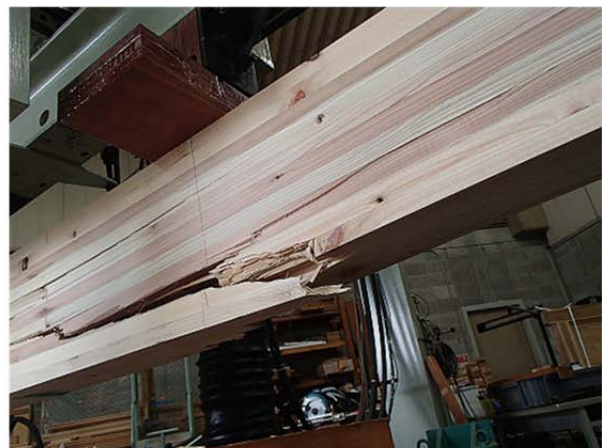
図3.1-20 AZN-I-5の曲げたわみー曲げ応力曲線 および破壊形態
