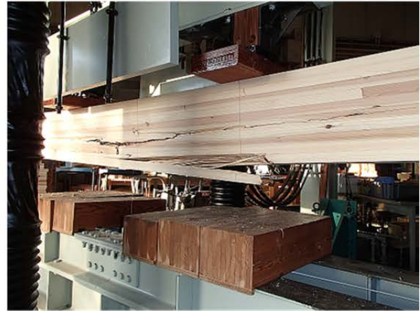
図3.1-10 AAC-I-5の曲げたわみー曲げ応力曲線 および破壊形態
