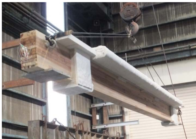
写真 4. 2-1 加熱試験前の集成材梁試験体
