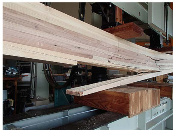
図3.1-14 AZN-4の曲げたわみー曲げ応力曲線および破壊形態
