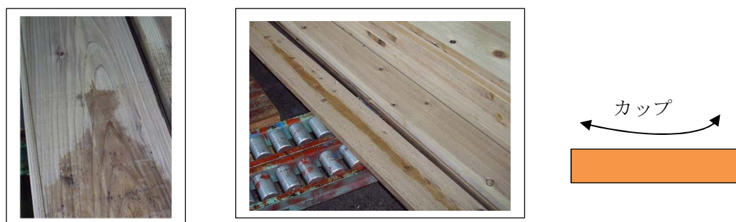
図 2.3-6 AAC 処理ラミナのカップと反りによる不具合
