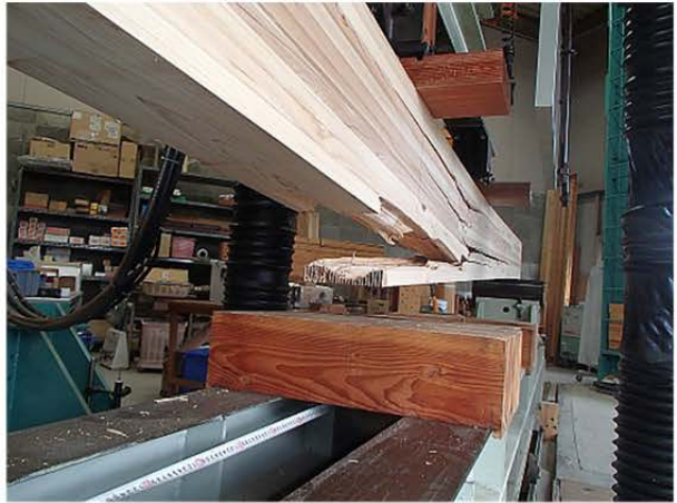
図3.1-1 AAC-1の曲げたわみー曲げ応力曲線および破壊形態
