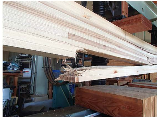
図3.1-7 AAC-I-2の曲げたわみー曲げ応力曲線 および破壊形態
