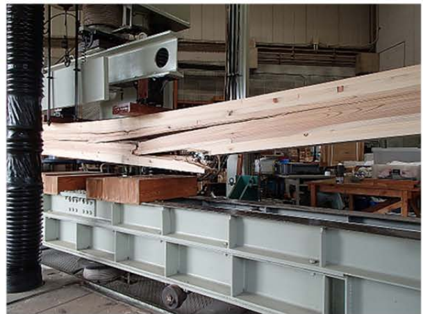
図3.1-5 AAC-5の曲げたわみー曲げ応力曲線および破壊形態
