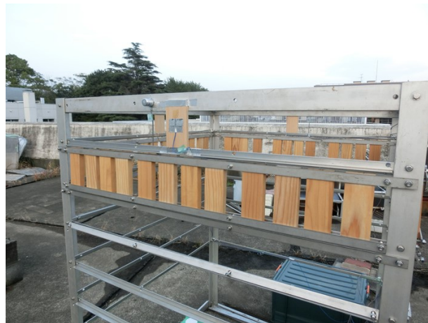
写真 暴露試験片と表面温度(熱電対)及び日射量(日射セル)の測定
