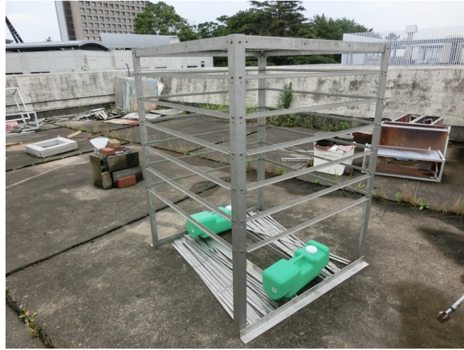
写真 東西南北垂直暴露架台
