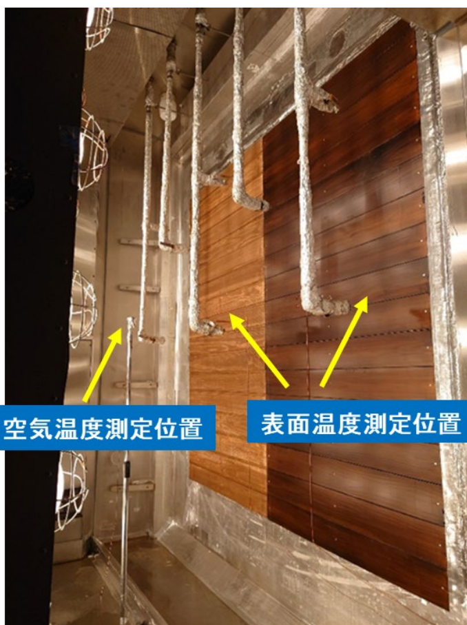
写真1 空気温度と試験体表面温度の測定位置（第1回目試験）
