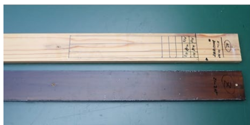
写真 17 試験体からの防腐・防蟻試験片の部位
