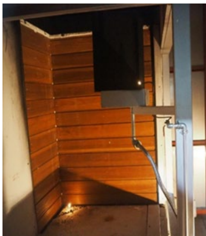
写真14 SBI試験の燃焼開始前 左下コーナー部は種火
