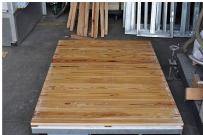
写真13 長翼試験体の作製状況
