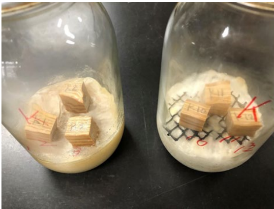
写真 18 防腐効力試験 (4 週間経過) (左：オオウズラタケ右：カワラタケ)
