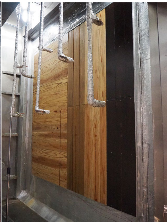
写真4 試験体前面（第2回目試験の開始前） 写真5 試験体前面（第2回目試験散水配管）
