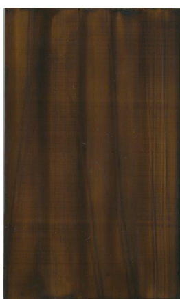
試験片 B 造膜塗装 (南面 暴露前)
