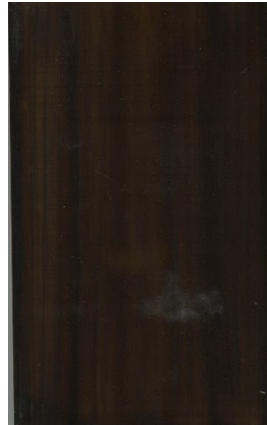
試験片 B 造膜塗装 (東面 暴露 12 ヶ月後) 試験片 B 無塗装 (東面 暴露 12 ヶ月後)
