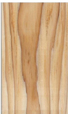
写真 28 東面暴露試験の試験片 B (造膜形塗装 or 無塗装)
