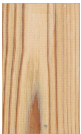
試験片 C 無塗装 (東面 暴露前)
