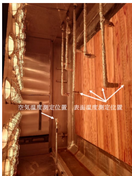
写真 1 促進劣化試験の状況と温度測定位置 乾燥過程を外気側より撮影
