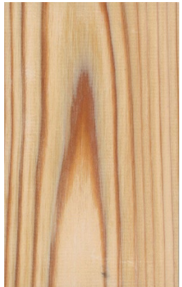
試験片 C 無塗装 (西面 暴露前)
