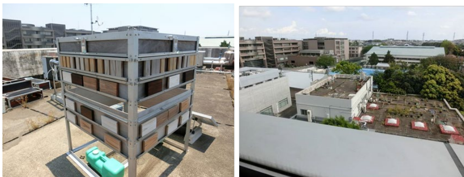
写真23 四面垂直暴露架台（左）と暴露場所である屋上（右）
