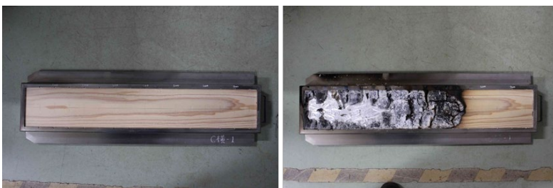
写真 22 無処理スギ試験体の試験前と試験後の状況
