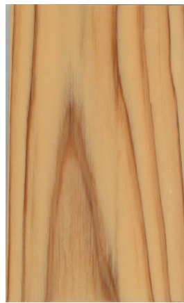
試験片 C 造膜塗装 (東面 暴露前)
