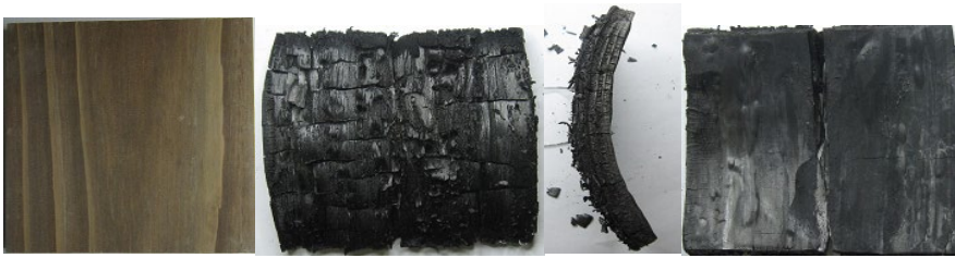
写真 13 ラージコーン試験での試験体 A 促進劣化有り-2 の状況（右から試験前、試験後正面、側辺、裏面）
