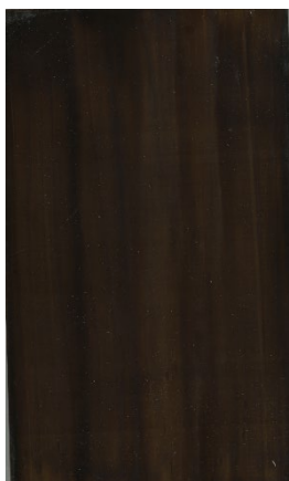
試験片 B 造膜塗装 (西面 暴露 12 ヶ月後) 試験片 B 無塗装 (西面 暴露 12 ヶ月後)
