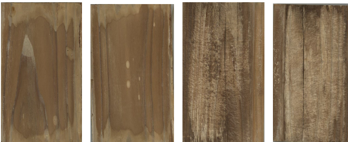
試験片 C 造膜塗装（南面 暴露 12 ヶ月後） 試験片 C 無塗装（南面 暴露 12 ヶ月後） 写真 34 南面暴露試験の試験片 C（造膜形塗装 or 無塗装）
