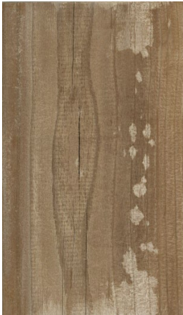
試験片 C 造膜塗装 (東面 暴露 12 ヶ月後) 試験片 C 無塗装 (東面 暴露 12 ヶ月後)
