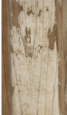
試験片 C 造膜塗装 (東面 暴露 12 ヶ月後) 試験片 C 無塗装 (東面 暴露 12 ヶ月後)
