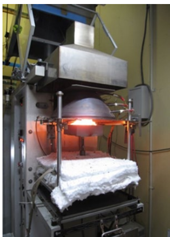
写真11 ラージコーンの試験装置
