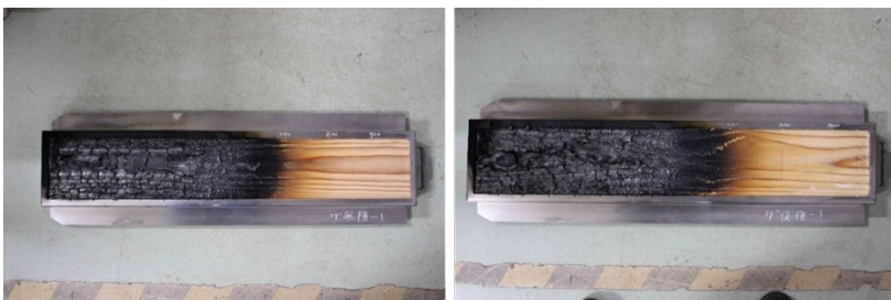
写真 18 試験体 B (横張) の「促進劣化無し」(左) と「促進劣化有り」(右) の状況
