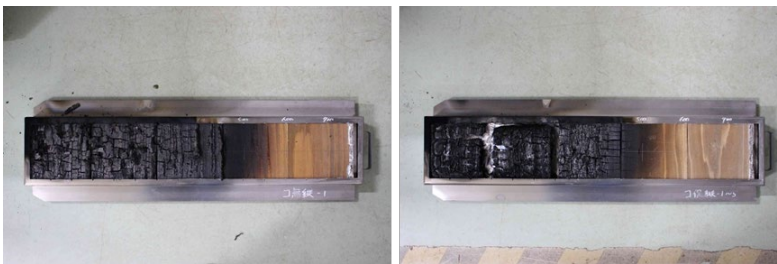
写真 21 試験体 A (縦張) の「促進劣化無し」(左) と「促進劣化有り」(右) の状況
