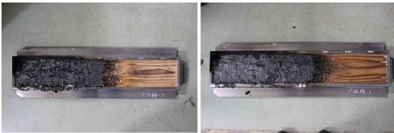
写真 20 試験体 D (横張) の「促進劣化無し」(左) と「促進劣化有り」(右) の状況
