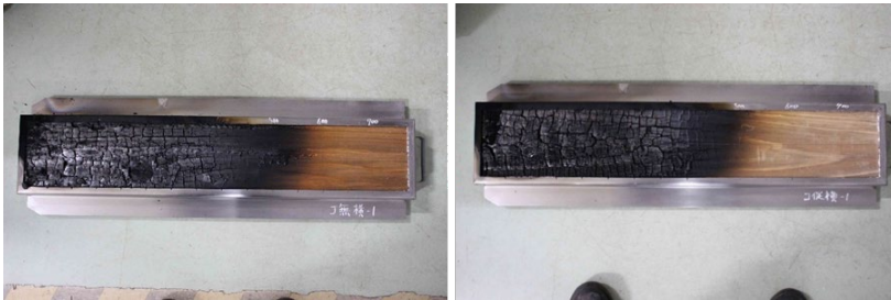
写真 17 試験体 A (横張) の「促進劣化無し」(左) と「促進劣化有り」(右) の状況
