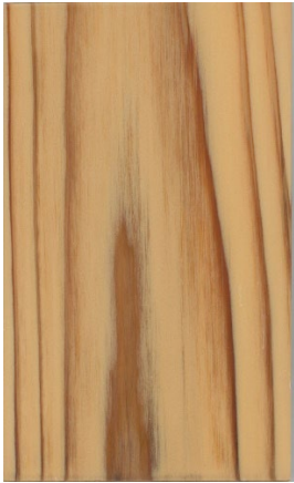
試験片 C 造膜塗装 (東面 暴露前)
