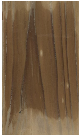
試験片 C 造膜塗装 (東面 暴露 12 ヶ月後) 試験片 C 無塗装 (東面 暴露 12 ヶ月後)
