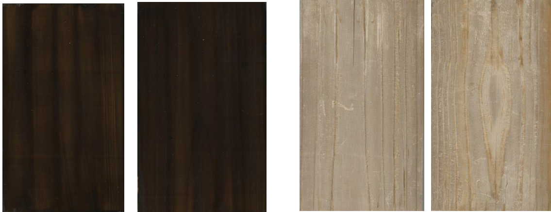
試験片 B 造膜塗装（南面 暴露 12 ヶ月後） 試験片 B 無塗装（南面 暴露 12 ヶ月後） 写真 30 南面暴露試験の試験片 B（造膜形塗装 or 無塗装）
