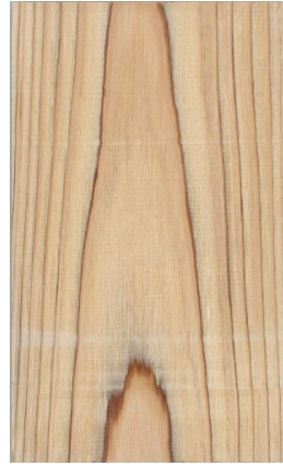
試験片 B 無塗装 (東面 暴露前)
