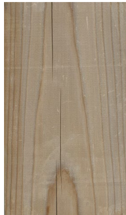
試験片 B 造膜塗装 (東面 暴露 12 ヶ月後) 試験片 B 無塗装 (東面 暴露 12 ヶ月後)
