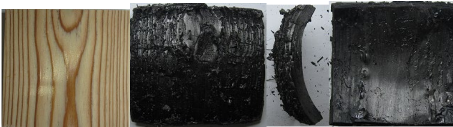
写真 14 ラージコーン試験での試験体 B 促進劣化無し-2 の状況（右から試験前、試験後正面、側辺、裏面）
