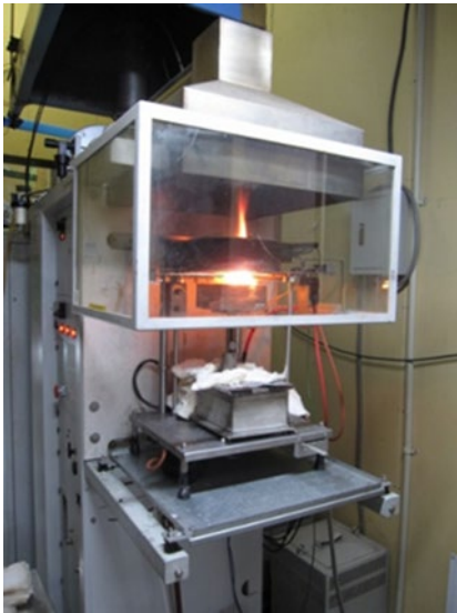
写真6 標準コーンの試験装置
