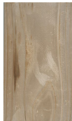
試験片 B 造膜塗装 (東面 暴露 12 ヶ月後) 試験片 B 無塗装 (東面 暴露 12 ヶ月後)
