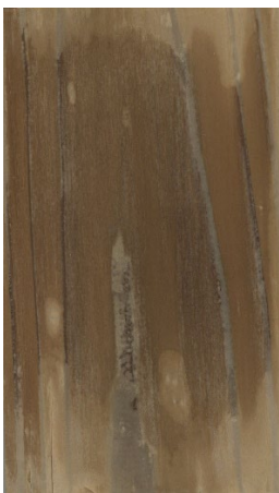
試験片 C 造膜塗装 (東面 暴露 12 ヶ月後) 試験片 C 無塗装 (東面 暴露 12 ヶ月後)
