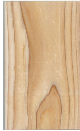
試験片 B 無塗装 (東面 暴露前)
