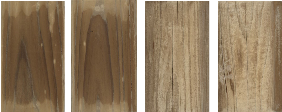
試験片 C 造膜塗装（西面 暴露 12 ヶ月後） 試験片 C 無塗装（西面 暴露 12 ヶ月後） 写真 33 西面暴露試験の試験片 C（造膜形塗装 or 無塗装）
