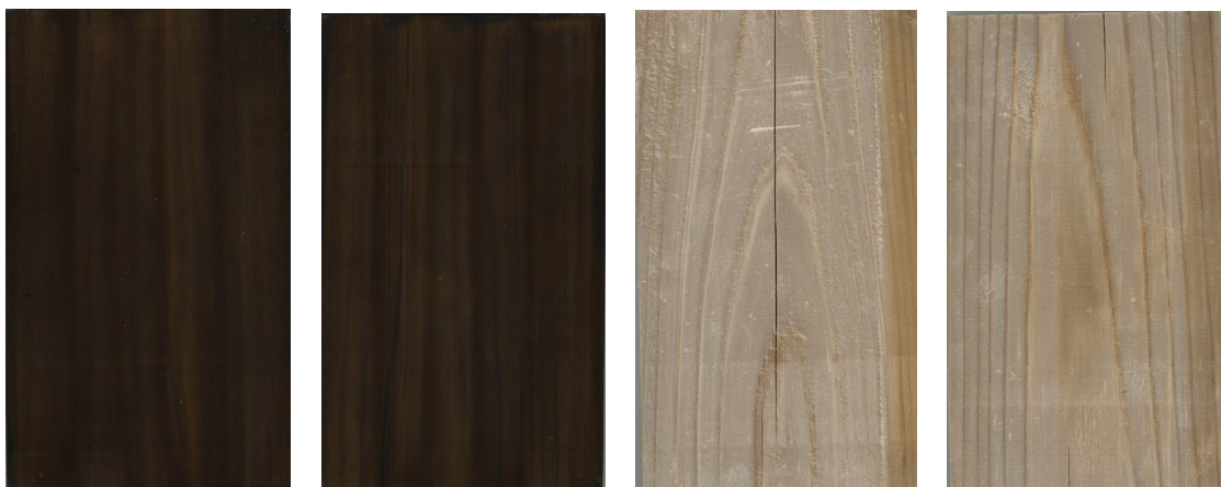
試験片 B 造膜塗装（北面 暴露 12 ヶ月後） 試験片 B 無塗装（北面 暴露 12 ヶ月後） 写真 31 北面暴露試験の試験片 B（造膜形塗装 or 無塗装）
