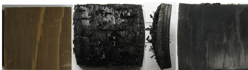
写真 8 試験体 A の促進劣化有り-3 の状況 (右から試験前、試験後正面、側辺、裏面)
