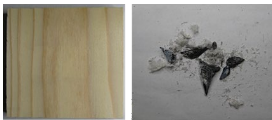
写真 10 スギ無処理-2 試験体の状況 (右 灰のみ)
