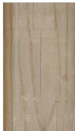
試験片 B 造膜塗装 (西面 暴露 12 ヶ月後) 試験片 B 無塗装 (西面 暴露 12 ヶ月後)
