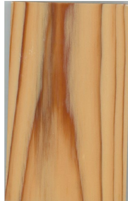
試験片 C 造膜塗装 (西面 暴露前)
