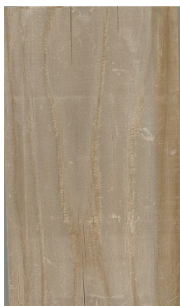
試験片 B 造膜塗装 (西面 暴露 12 ヶ月後) 試験片 B 無塗装 (西面 暴露 12 ヶ月後)
