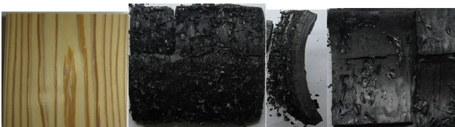
写真 15 ラージコーン試験での試験体 B 促進劣化有り-3 の状況（右から試験前、試験後正面、側辺、裏面）
