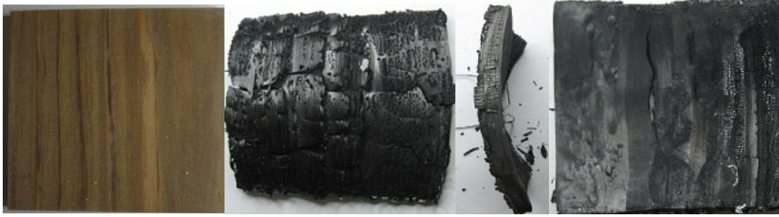
写真 12 ラージコーン試験での試験体 A 促進劣化無し-2 の状況（右から試験前、試験後正面、側辺、裏面）
