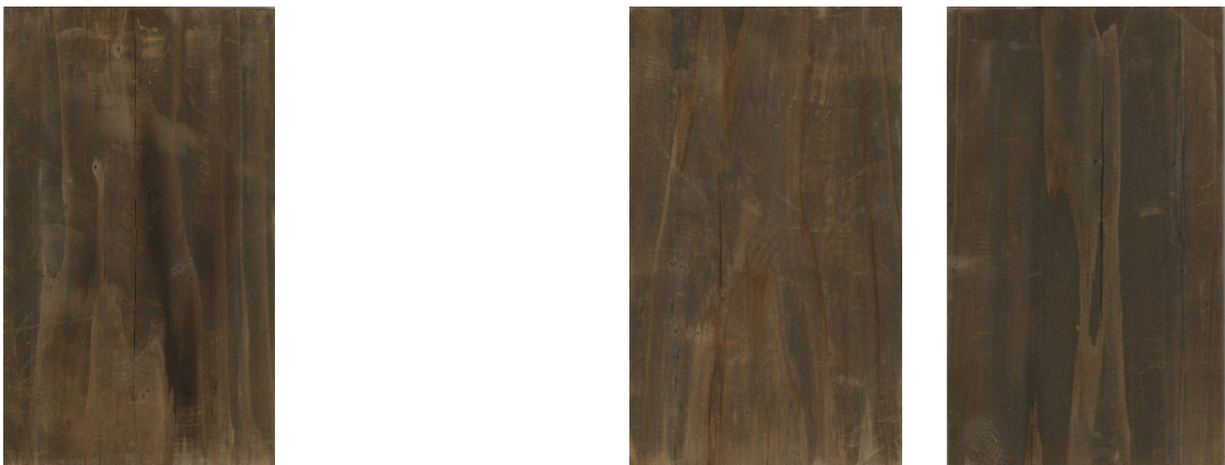
試験片 A (南面 暴露 12 ヶ月後)
