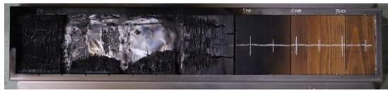
写真 2.4-4 火炎伝播試験前後の試験体表面の様子（III-V、左：試験前、右：試験後）
