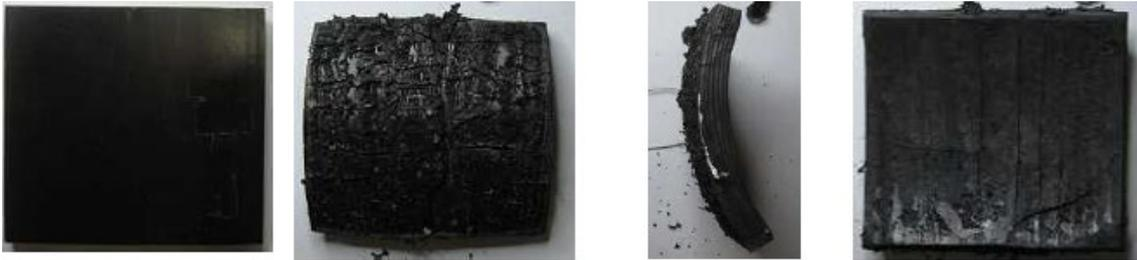
写真 2.5-2 試験体II'の試験前後の状況（左から試験前、試験後正面、側辺、裏面）
