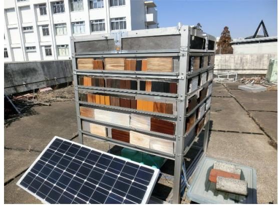
写真 2.7-3 四面暴露架台と暴露試験
