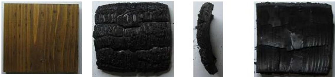
写真 2.5-3 試験体IIIの試験前後の状況（左から試験前、試験後正面、側辺、裏面）
