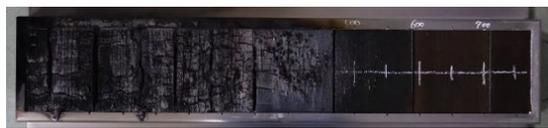
写真 2.4-2 火炎伝播試験前後の試験体表面の様子（II'-V、左：試験前、右：試験後）
