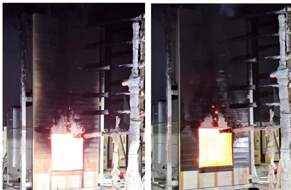
写真 2.3-4 加熱終了直後の様子（左：試験体 I'、右：試験体 II'）
