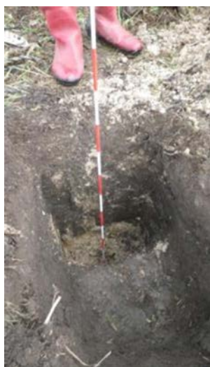
写真3 センサ設置面の整地
