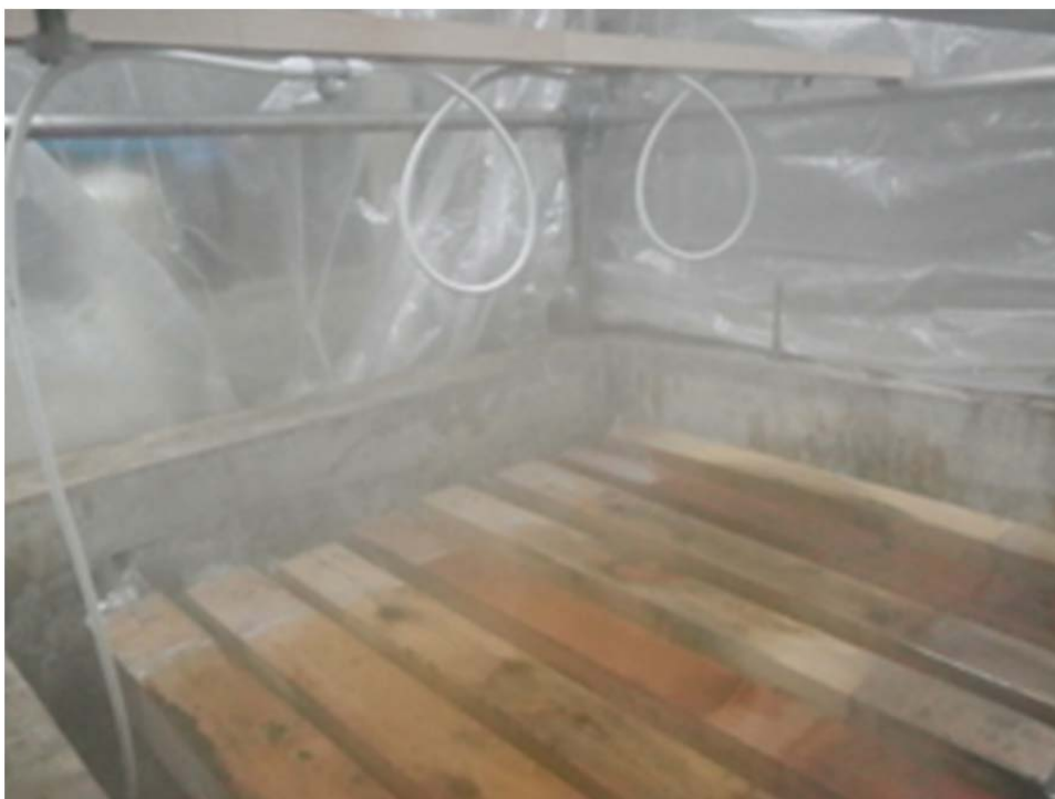
写真 5.3 ミストシャワーによる散水状況
