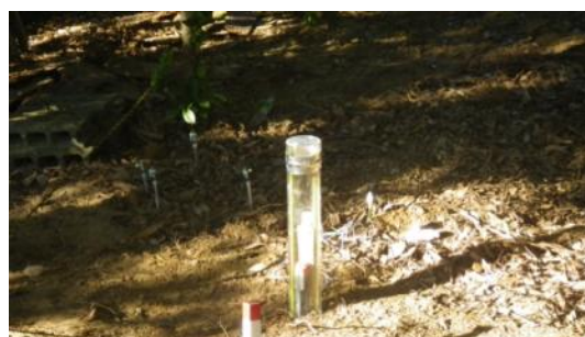
写真 9 ロガー保護のためのアクリルパイプ
