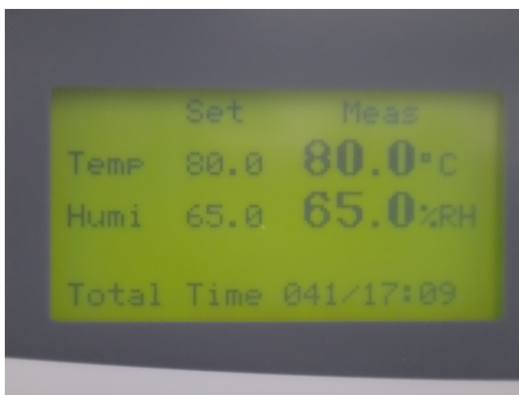
図 3.5-2 恒温恒湿器の設定（暴露温度 80℃）
