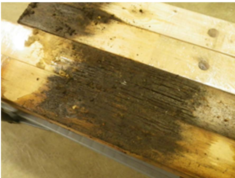
写真 5.4 ファンガスセラーから取出したベイツガ試験体
