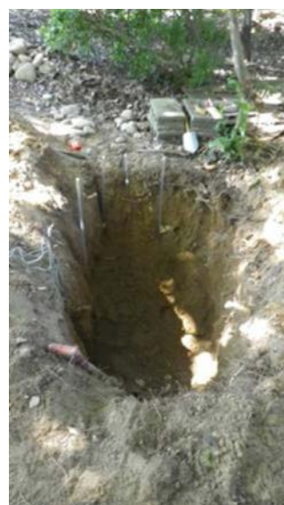
写真 7 整形した断面へのセンサ類およびパイプ類の設置状況
