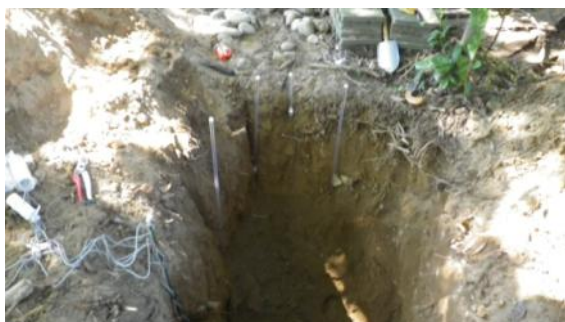
写真 7 整形した断面へのセンサ類およびパイプ類の設置状況
