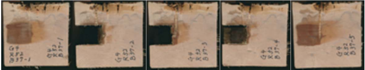
写真 5.7 土台釘接合部の切断面 (TP ID : G4R52P17B37)
