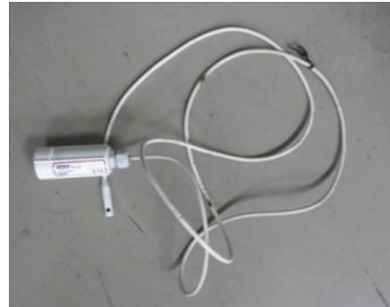
写真18 地表温測定用センサー一体型ロガー
