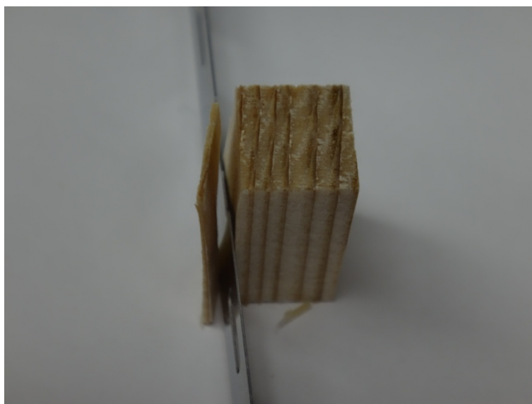
図 3.5-4 ミクロトーム用の替刃で試験体を切断
