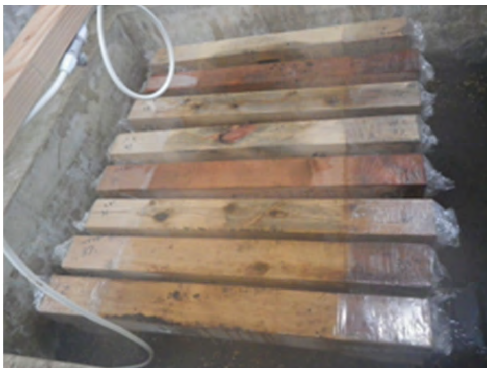
写真 5.2.5 土台用（材中間部） ファンガスセラー
