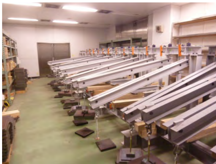
図 3.1 曲げクリープ破壊試験の試験装置 概要
