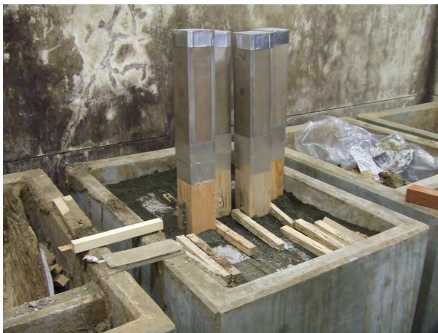
写真 5.2.2 イエシロアリによる強制劣化方法の検討 （接合部モデル試験体が複数同時の場合）
