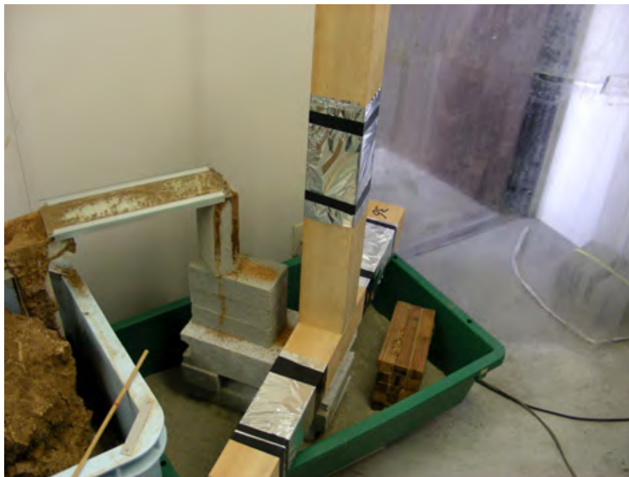
写真 5.2.1 イエシロアリによる強制劣化方法の検討 （接合部モデル試験体が単体のみの場合）
