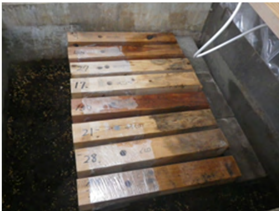
写真 5.2.6 柱用（材端部）ファンガスセラー
