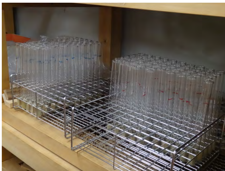
図 3.3-4 温度 20℃、湿度 65%の恒温恒湿室内で暴露している様子
