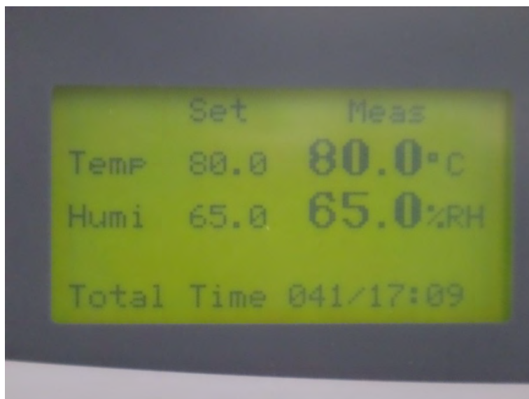
図 3.3-2 恒温恒湿器の設定例（温度 80℃、湿度 65%）
